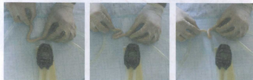
Рис. 2. Измерение градиента давления и объема жидкости, циркулирующей в системе за минуту, при разных видах извитости.
